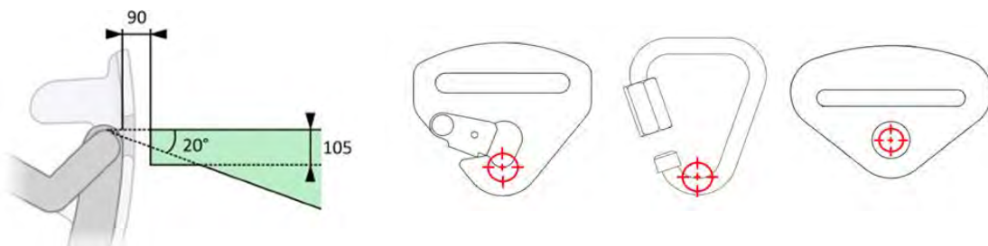
Beispiele von Anlenkpunkten der Gurtbefestigung Zeichnung 253-61-c
