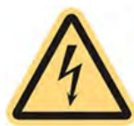
Zeichnung 1 Markierung von Teilen und Stromkreisen der Spannungsstufe B
