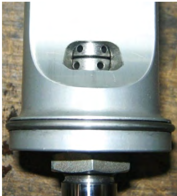
Doppelt einstellbare Einrohrbauweise
